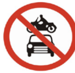
423 ممنوع لجميع المركبات الميكانيكية All Motor Vehicles Prohibited
